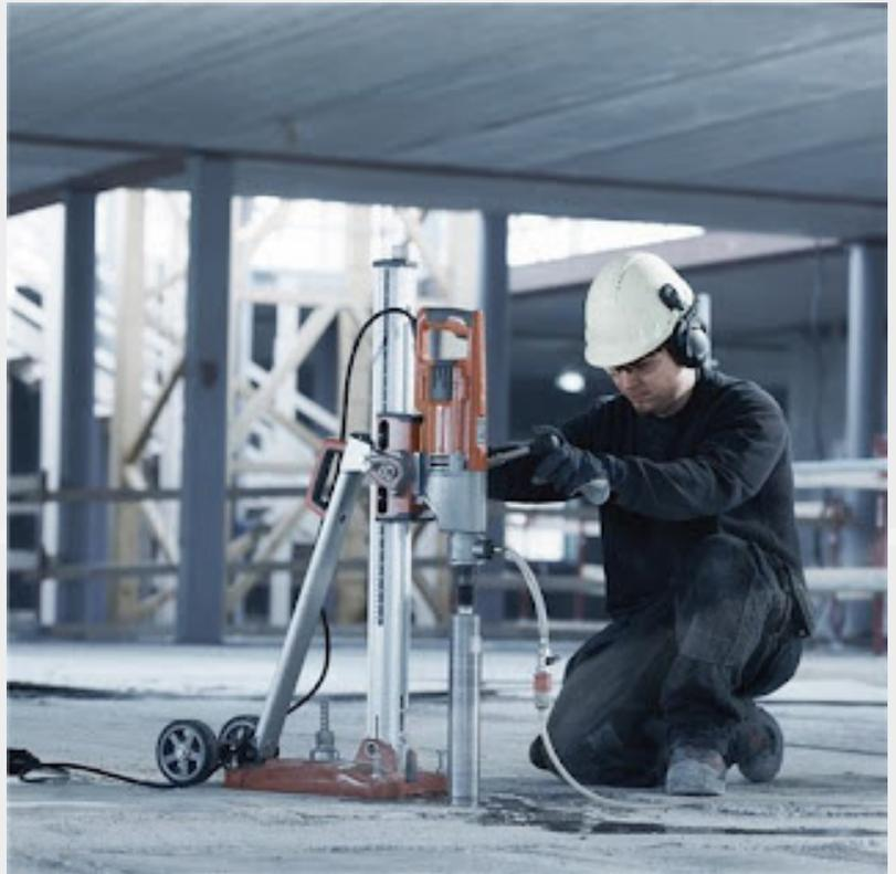
Pengujian fisik pada pemeriksaan pekerjaan konstruksi jalan identik dengan pengambilan benda uji/sampel di lapangan. Namun demikian pengujian fisik ini harus dilakukan berdasarkan hasil pengujian Sistem Pengendalian Intern (SPI) yang memadai sehingga ada indikasi yang kuat bahwa fisik jalan tidak memenuhi spesifikasi sebagaimana diatur dalam kontrak. Pengujian SPI dapat dilakukan salah satunya dengan menguji pengendalian mutu yang dilaksanakan oleh penyedia.
