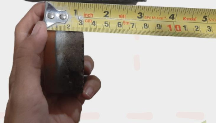
Pengukuran dilakukan sebanyak 9 pengukuran yang terdiri dari satu pengukuran pada posisi tengah, dan 8 pengukuran pada sisi-sisi benda uji
