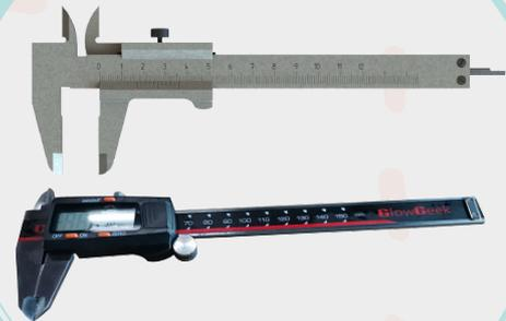
pengukuran ketebalan dengan jangka sorong minimal pada tiga sisi dengan toleransi ketebalan pada tabel 2
